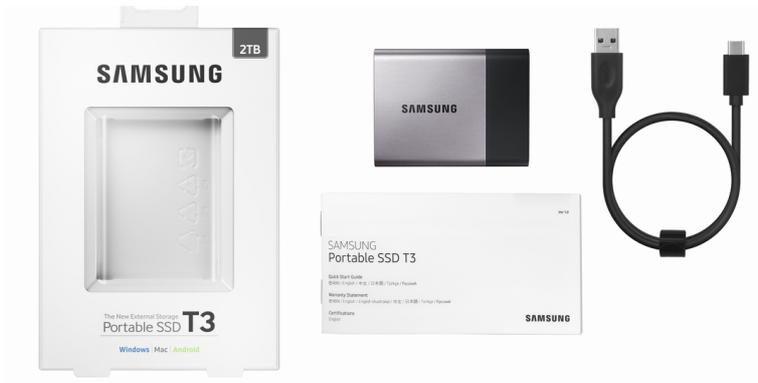
Samsung Portable SSD T3(以下、T3)シリーズは、スマートなデザインで高いパフォーマンスとセキュリティを実現するポータブル SSD です。横 74mm、縦 58mm と名刺とほぼ同サイズで、僅か 10.5mm 厚の筐体に最大 2TB の超高速 SSD を搭載。質量も最大 51g とポケットに入れているのを忘れてしまう超軽量化を実現。AES 256bit ハードウェア暗号化機能と信頼の延長保証\*1により、マイナンバーや大容量の CAD データなどの重要データを安全に持ち運びできます。
